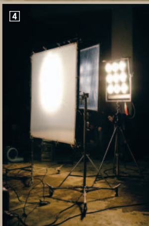
1 Keine Filmproduktion ohne „good guy“. 2 Ruckelfreie Kamerafahrten entstehen auf Schienen. 3 Mit dem Grauglas legt Oberbeleuchter Locasso die Lichtrichtung fest. 4 Das Kunstlicht wird erst neutral gefiltert und dann mit Streufolie weicher gemacht. 5 Mit dem Easyrig-Tragegestell kann Marc Rogoll die Kamera per Hand führen. 6 Die Musik ist synchron zum Timecode auf der Filmklappe.
