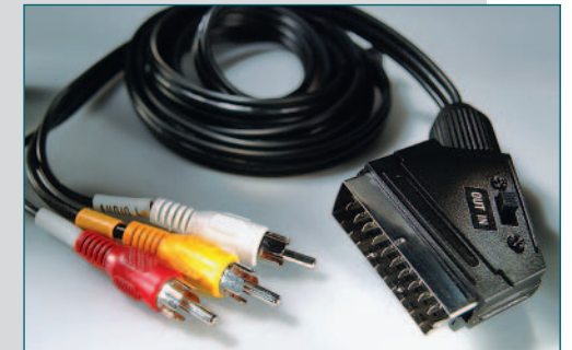
ADAPTER: Steht der Schieber auf »Out«, überträgt der Scart-Anschluss Videosignale (gelb) sowie Stereoton (weiß und rot).
